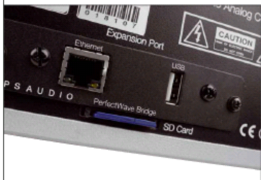
Auf SD-Karte ruht das Betriebssystem für die Bridge, was Updates vereinfacht
